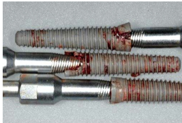
شکل ۳-۷. ایمپلنت‌های شکسته شده در حین قراردهی که باید خارج شوند.
